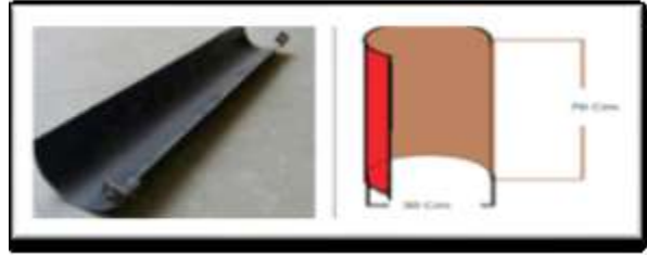
الشكل (3) يوضح شفرة الدوار التوربين
