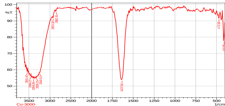
الشكل 10: طيف الأشعة تحت الحمراء لجسيمات النحاس النانوية المحضرة بـ (3000 Pulse/sec)
