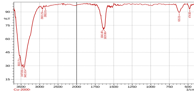
الشكل 9: طيف الأشعة تحت الحمراء لجسيمات النحاس النانوية المحضرة بـ (2000 Pulse/sec)
