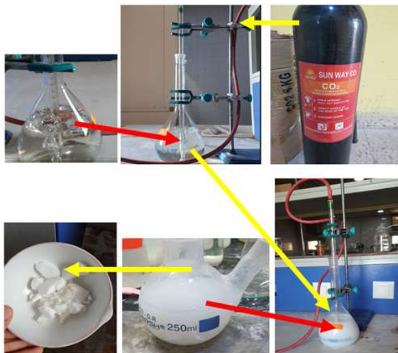
الشكل 5: صور فوتوغرافية تمثل عمليات إضافة غاز \text{CO}_2 الى محلول الومينات الصوديوم القلوية والحصول على الراسب الأبيض
