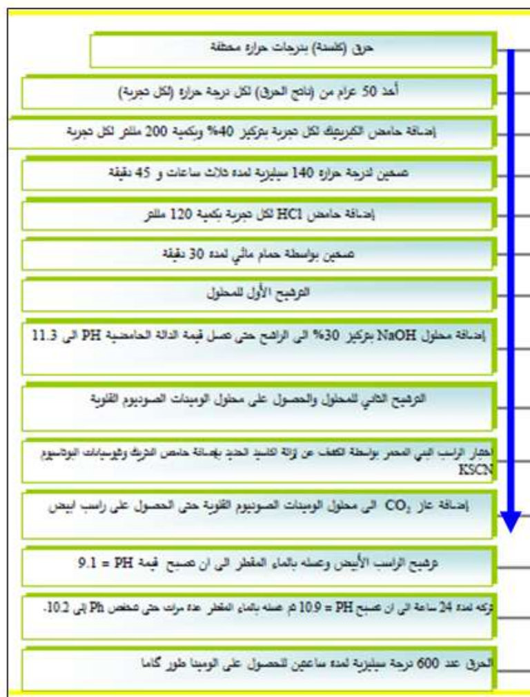
الشكل 3: مخطط انسيابي يوضح العمليات التي أجريت لغرض خلب (استخلاص) الألومينا من الكاؤولين
